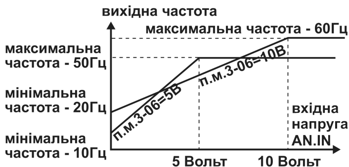
Рисунок 13. Масштабування AN.IN по верхній межі діапазону сигналу.
