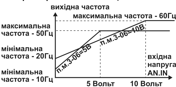
Рисунок 13. Масштабування AN.IN по верхній межі діапазону сигналу.
