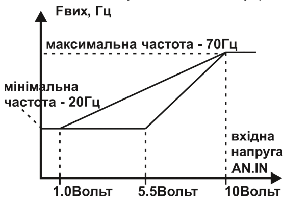
Рисунок 12. Масштабування AN.IN по нижній межі діапазону сигналу.
